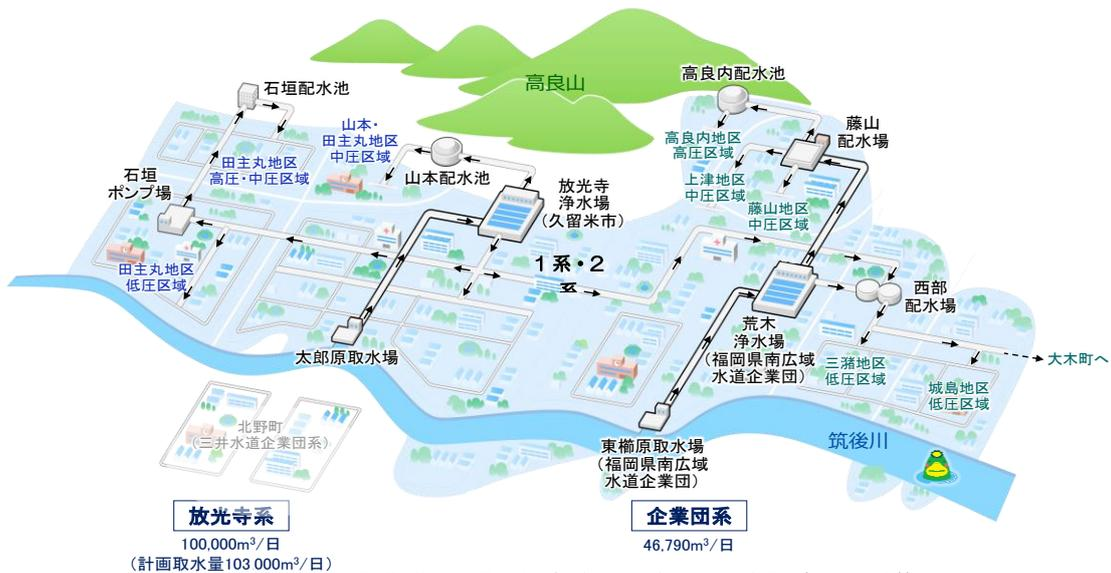
図 2-2-1 久留米市給水区域配水系統図（イメージ）
