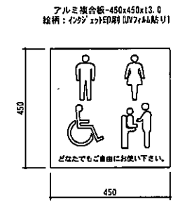
アルミ合金板-450x450x13.0 絵柄:インクジェット印刷UV7(AA)貼付 ベース:白、文字:黒 マ/男、子:青、女:子・ベビ:ー:赤、車いす:緑 ピクトサイン詳細図 Scale 1:10
