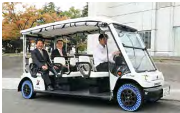
本庁舎前で試乗する原口市長と田村代表執行役（後列右）。樹脂製の青いパーツが車体を支えます
