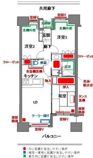
風の流れと空気・水蒸気の滞留場所
