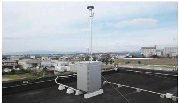
田主丸中学校に設置しているPM2.5の測定器
