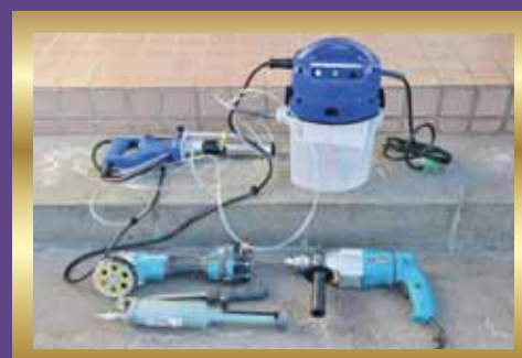
上段の水流式(湿式)ドリルは、タイル等にもひび割れなく穴を開けることができる
