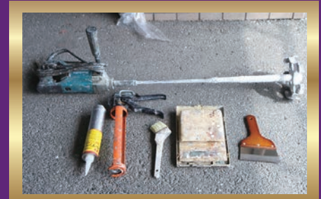
防水加工の道具（コーキング剤、コーキングガン、はけ、はかり、ヘラ、攪拌機）
