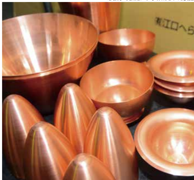
へら鉸りの技術により作成された製品
