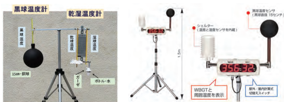
図1-18 暑さ指数(WBGT)測定装置 (左) 基本型 (右) 電子式
