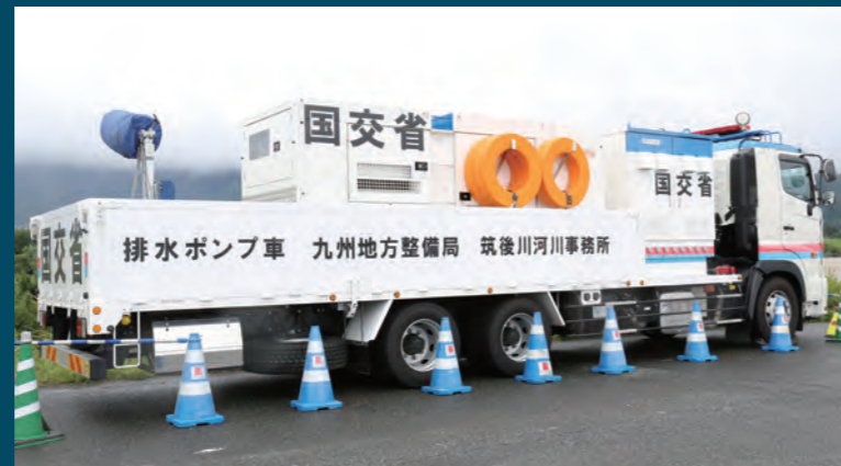
国交省に要請し、旧陣屋川樋管に配置された排水ポンプ車
