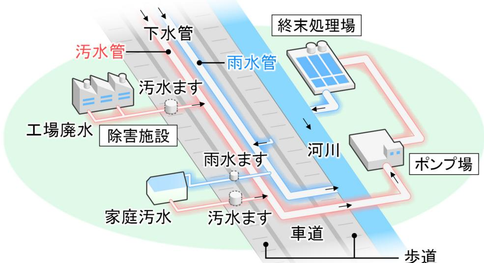
図 3-1-1 下水道概要図（分流式）
