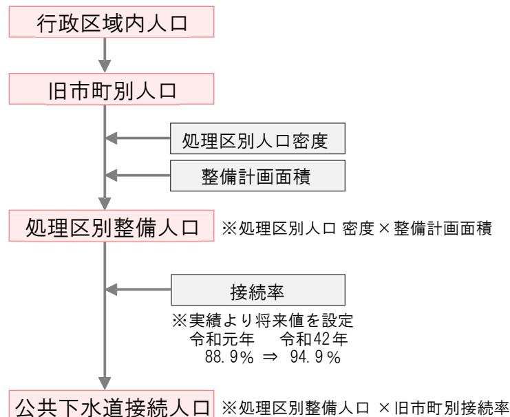
図 3-1-23 公共下水道接続人口の算定フロー
