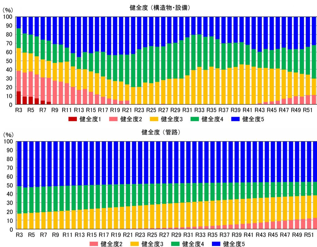
図3-1-30 下水道施設の健全度の推移（ストックマネジメント計画に基づき更新した場合）
