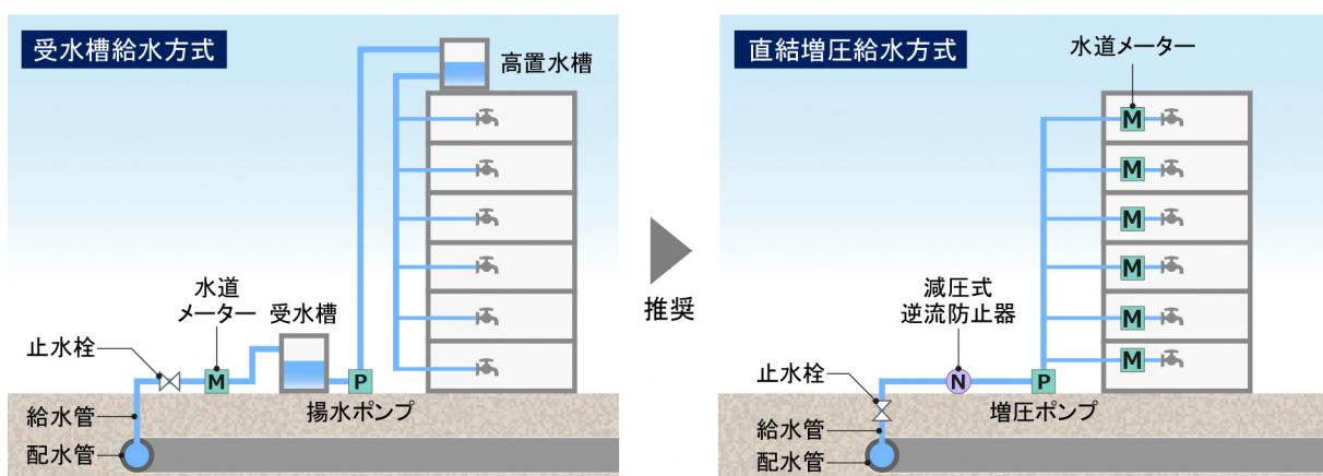
図2-4-1 直結増圧給水方式の推奨
