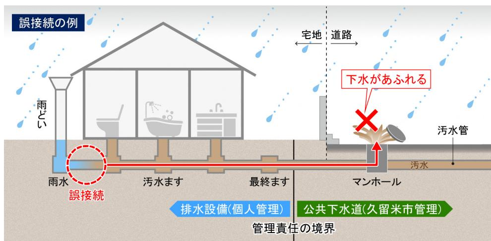
図3-4-4 雨水管の誤接続（イメージ）
