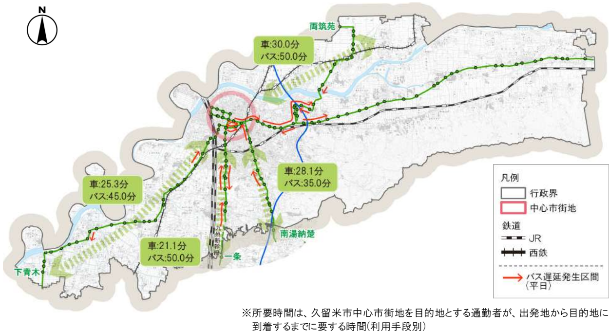
図 路線バスによる中心市街地までの所要時間と遅延発生区間(平日)
