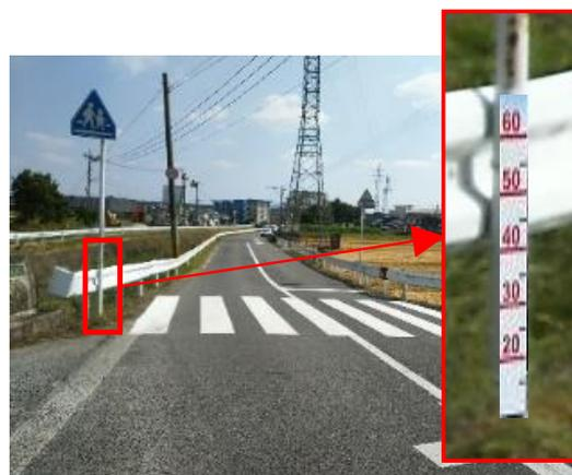
図：洪水標識(想定浸水深)の設置イメージ
