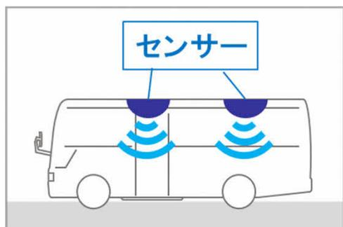
エンジン停止から一定時間後に**センサーによる車内の検知を開始**
