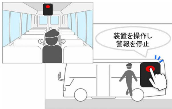
車内を確認し、運転者等が車両後部の装置を操作すると**警報が停止**
