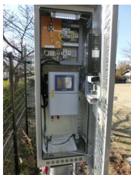
▲ 遠隔監視装置による残留塩素の測定 (城島町西青木の残留塩素モニター)
