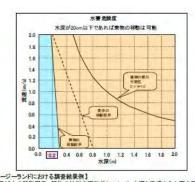
【ニュージーランドにおける調査結果例】 浸水区域内の移動服界、雑物の接近の可能性について、水深と流速から上図を示している 出典 「Draft Catchment Management Plan Openuku Stream,henderson Valley Summary Report & Drawing)中の図を加重・棒正
